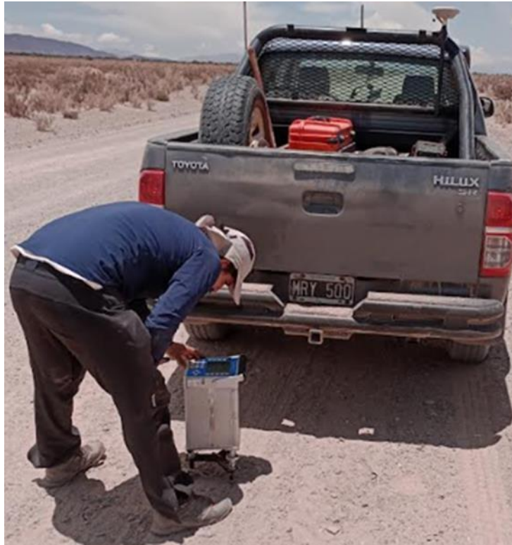
Figura: Operación de medición con un gravímetro automático Scintrex CG5, las coordenadas son determinadas mediante DGPS, con un sistema Trimble 5700 equipado con antena geodésica y controladoras Trimble Recon.
