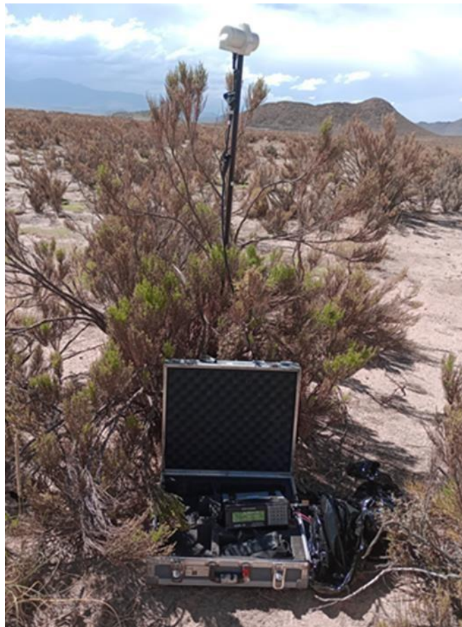
Figura: Base magnética instalada en Aguas Calientes. Magnetómetros GEM System Overhauser, modelo 19 V7.
